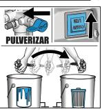
Para poupar tinta no tubo, desengate o fecho do gatilho e acione a pistola para o balde de resíduos, rode a válvula de ferrar/pintar para a posição SPRAY (Pintar) e coloque o interruptor na posição ON (Ligar). Quando a água sair da pistola, mantenha a pistola acionada e apontada para o balde de resíduos. Continue a lavar até que a água saia transparente.
