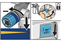
6 Rode o botão de controlo da pressão para a regulação mais baixa e solte o gatilho. Desengate o fecho do gatilho. Rode a válvula de ferrar/pintar para a posição PRIME (Ferrar) e coloque o interruptor na posição OFF (Deslicar).
