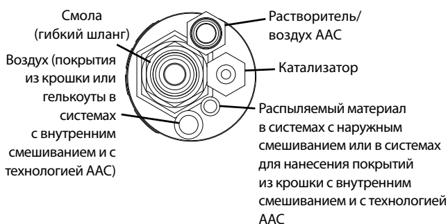
Рис. 6: Схема концов шланга
