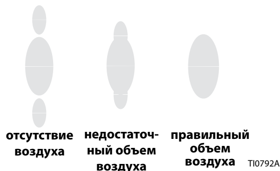
Рис. 5. Проблемы с формой окрасочного факела
