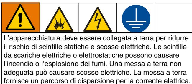
**Sistema:** Mettere a terra utilizzando il morsetto di terra nell'armadio elettrico. Vedere **Collegamento elettrico**, pagina 20.
