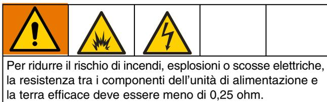
3. Collegare il filo di terra al morsetto di terra. Richiedere a un tecnico elettricista qualificato di effettuare un controllo della resistenza tra la terra di ciascun sistema Therm-O-Flow e la presa di terra efficace. La resistenza deve essere inferiore a 0.1 ohm. Se la resistenza è superiore a 0,1 ohm, potrebbe essere necessario individuare un'ubicazione differente per il pozzetto di terra. Non utilizzare il sistema fin quando il problema non è stato corretto.
