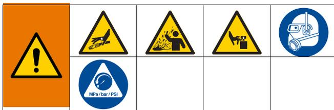
Questa apparecchiatura rimane pressurizzata finché la pressione non viene scaricata manualmente. Per evitare gravi lesioni causate dal fluido pressurizzato, ad esempio iniezioni nella pelle, schizzi di fluido e parti in movimento, seguire la **Procedura di scarico della pressione** quando si smette di spruzzare e prima di pulire, verificare o eseguire la manutenzione dell'apparecchiatura.
