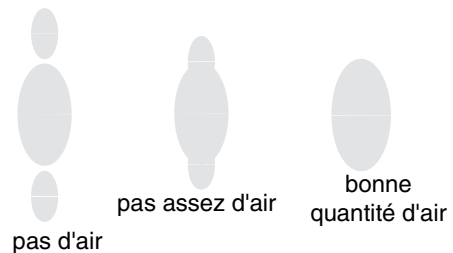
FIG. 8. Problèmes de jet de pulvérisation
