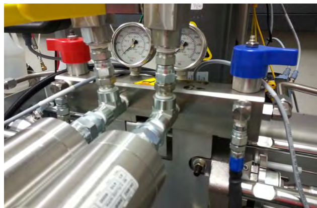
図 27: 手動循環位置の HFR マニホールドバルブ
