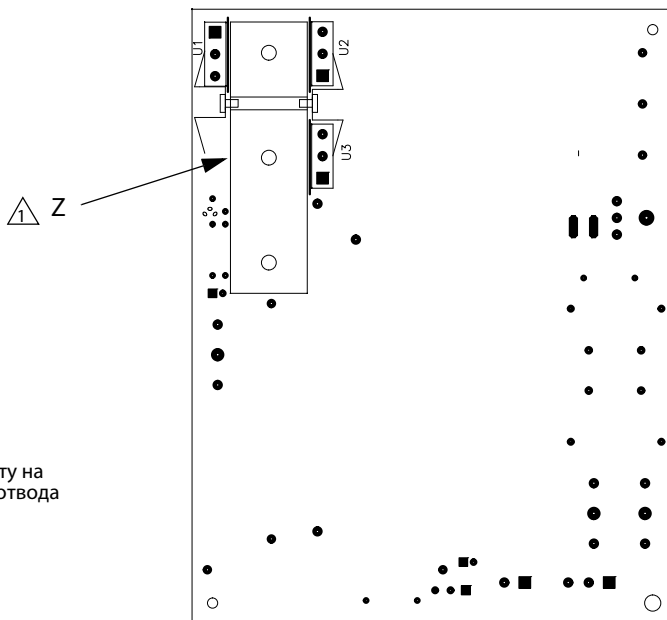
Задняя сторона экранирующей платы, показан теплоотвод (Z)
