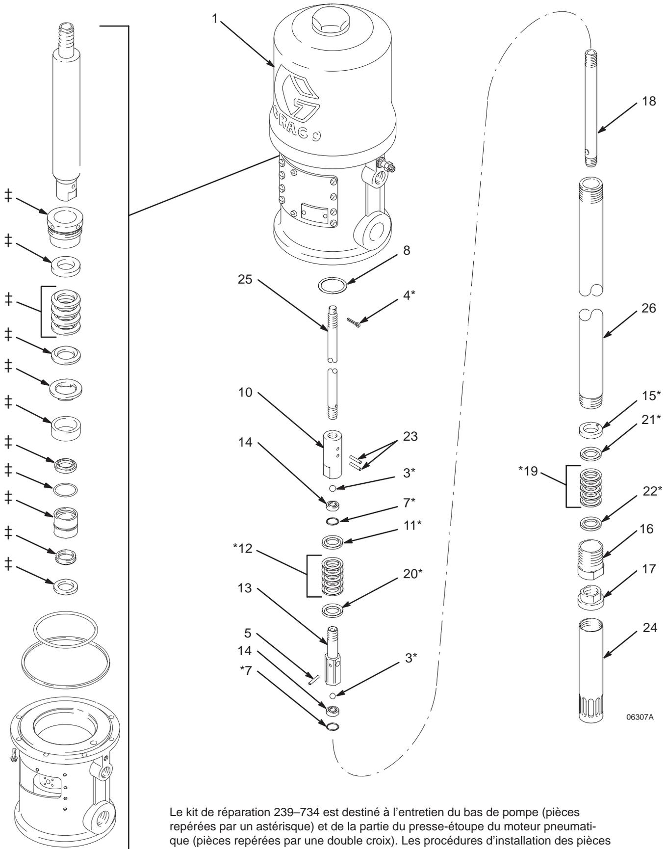
Le kit de réparation 239-734 est destiné à l'entretien du bas de pompe (pièces repérées par un astérisque) et de la partie du presse-étoupe du moteur pneumatique (pièces repérées par une double croix). Les procédures d'installation des pièces du presse-étoupe figurent dans le manuel d'instructions du moteur pneumatique, 306-982, qui fait partie du kit de réparation 239-734.
